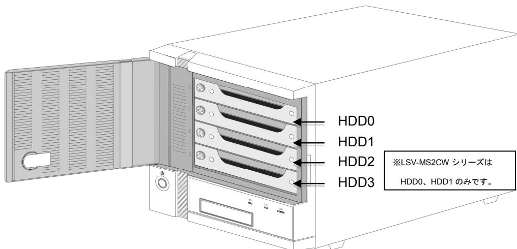
④ HDD 固定ネジを左方向に回し緩め、ネジのロックが外れた事を確認してからゆっくりとドライブを引き抜きます(出荷時、HDD 固定ネジが固く締められていることがあります。その場合はプラスドライバを用いて固定ネジを緩めてください)。片手を添えてドライブに衝撃が加わらないようにご注意ください。
