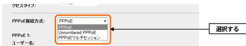
**4 プロバイダから指定されたユーザー名やパスワードなど必要な情報の入力と、オプションなどを設定します。設定が終われば **適用** をクリックします。**
