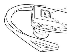
電源がオンになると、ランプが約2秒間隔で点滅し、ペアリング済みの機器を検索します。ペアリング済みの機器が周りにないときは、ランプが青色に点灯し、ペアリングモードになります。
