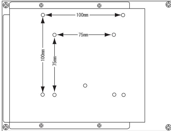
内側が75mmピッチ、外側が100mmピッチに対応しています。
