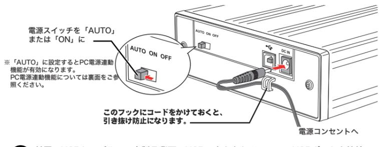
4 付属のUSBケーブルで、本製品背面のUSBコネクタとパソコンのUSBポートを接続してください。
