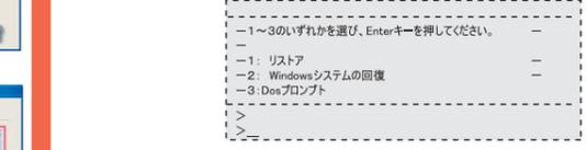
④バックアップイメージ復元プログラムが起動します。「処理を選択してください。」と表示されるので、「1」のカーソルで、「>リストア」を選択し、「Enter」キーを押してください。
