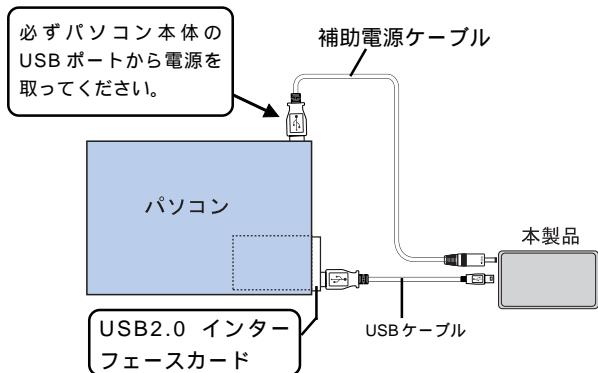
補助電源ケーブルのDCプラグはバスパワー対応機器(本製品)側に接続してください。
