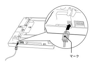
接続後、自動的にLWN-A54APS内部にある2つのダイバシティアンテナの片方のアンテナと切り替わり、電波の送受信を始めます。この後は、本製品を見通しの良い場所に設置してご使用ください。
