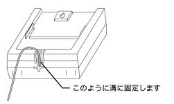
アンテナケーブルを固定したら、背面のスタンドを下図のよ うに引き出してご使用ください。
